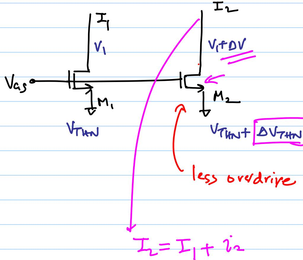
$$i_2 = -g_{m2} \Delta V_{THN} + \frac{\Delta V}{R_o}$$
