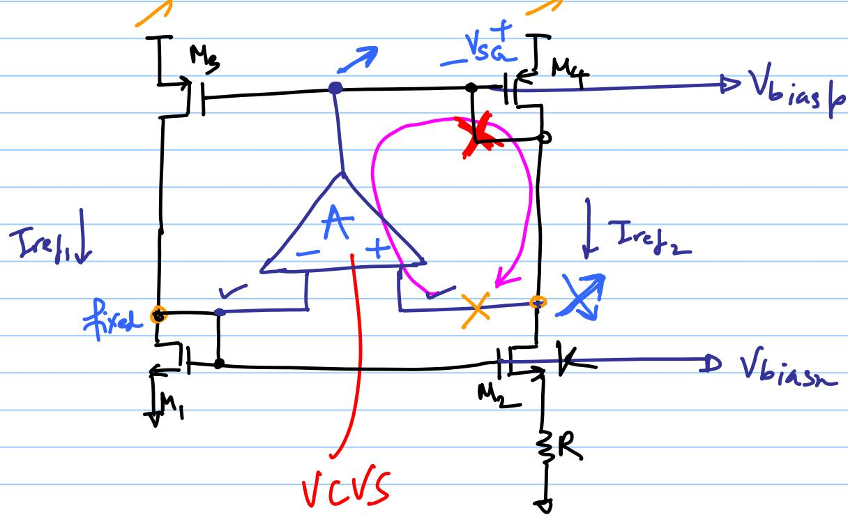
$-V_{c}$  feedback loop
