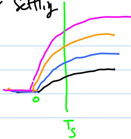
$$V_{final} (1 - e^{-\omega_{n,loop} \cdot T_s})$$
