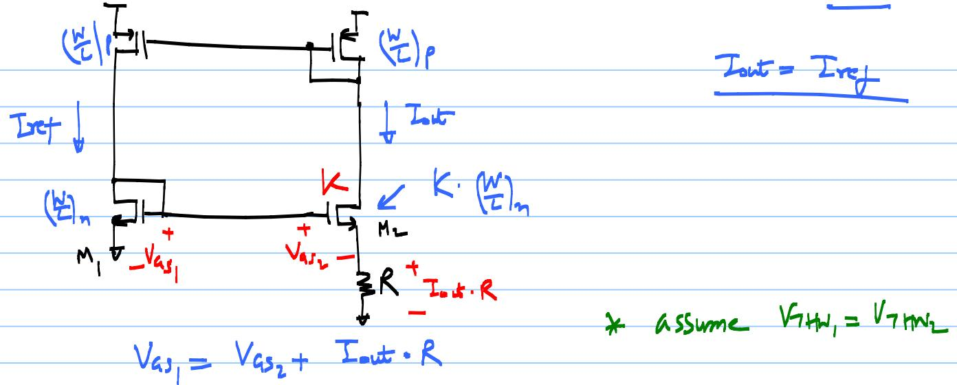
$$\sqrt{\frac{2 I_{out}}{K P_n \left(\frac{W}{L}\right)_1}} + V_{ThN_1} = \sqrt{\frac{2 I_{out}}{K P_n \left(\frac{W}{L}\right)_2 K}} + V_{ThN_2} + I_{out} \cdot R$$
