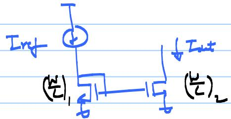
$V_{T+N_1} \neq V_{T+N_2}$
