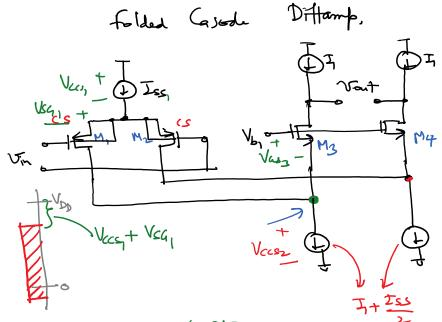
VSD,  $\geq V_{SD,Sat} = V_{SG_1} - |V_{THP}|$   $V_{SD_1} \geq V_{S-} V_{G_1} - |V_{THP}|$   $V_{SD_2} \geq V_{S-} V_{G_1} - |V_{THP}|$   $V_{G_1} \geq V_{G_2} - |V_{THP}|$   $V_{G_3} + V_{G_3} - |V_{THP}|$   $V_{G_3} + V_{G_3} - |V_{THP}|$   $V_{DS,Sat} - |V_{THP}| < 0$
