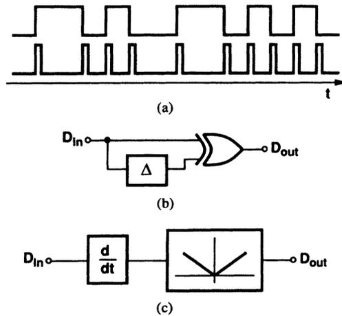
Fig. 60 Edge detection of NRZ data.
