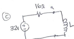
$$i_L(t) = (I_0 - I_{00}) e^{-t/\gamma} + I_{00}$$
