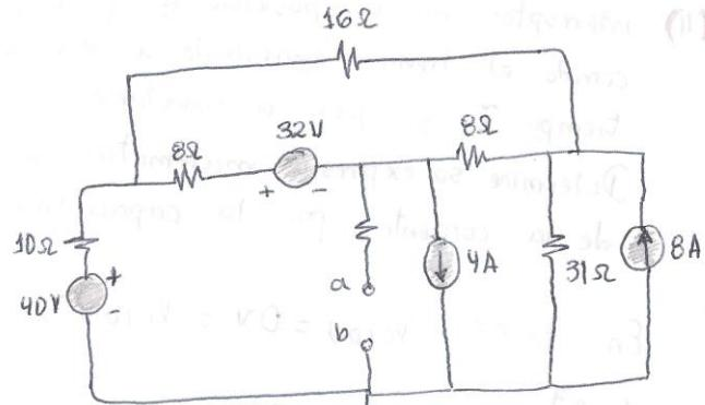
entre los nodos "a" y "b" conectamos una inductancia de valor  $\frac{4 \text{ mH}}{\text{sin energía}}$ , sin energía inicial. Calcule el Voltaje  $V_L(t)$  y la energía almacenada en esta  $L$ .
