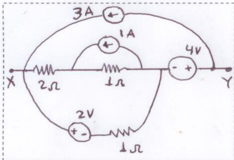
5. (4 Pts) Para el circuito de la figura encuentre el valor corrientes y voltajes en cada rama y demuestre el balance energético
