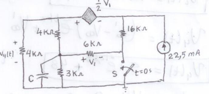
5) Extra: Calcule el eguivalente de Thevenin visto por la capacitancia. C = 10 mF.
